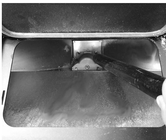
Fig. 17 - Pulizia serbatoio
